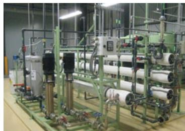
逆浸透膜を用いたろ過装置
