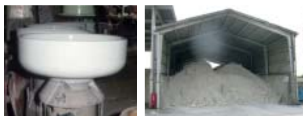
ガイシの組立工程でセメントの余剰分が発生 スtockヤードでセメントセラミック原料を自然乾燥
