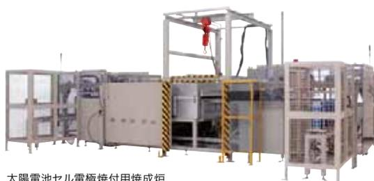
太陽電池セル電極焼付用焼成炉 (ウォーキングビーム炉)
