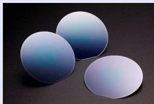
スマートフォンなどの無線通信機器に使用される電子部品の一つで、特定周波数の電波を取り出す役割を担い、通信品質を向上させる。AIが搭載されるハイエンドのスマートフォンなどで採用が進む。
