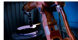
チャンバー部材 (アルミ、溶射)
